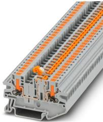
Messertrennklemme, Nennspannung: 400 V, Nennstrom: 20 A, Anschlussart: Push-in-Anschluss, Bemessungsquerschnitt: 2,5 mm<sup>2</sup>, Querschnitt: 0,14 mm<sup>2</sup> - 4 mm<sup>2</sup>, Montage: NS 35/7,5, NS 35/15, Farbe: grau
