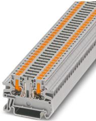
Trennklemme, Strom und Spannung werden durch den eingesetzten Stecker bestimmt., Nennspannung: 400 V, Nennstrom: 20 A, Anschlussart: Push-in-Anschluss, Bemessungsquerschnitt: 2,5 mm<sup>2</sup>, Querschnitt: 0,14 mm<sup>2</sup> - 4 mm<sup>2</sup>, Montage: NS 35/7,5, NS 35/15, Farbe: grau
