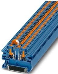
Messertrennklemme, Nennspannung: 400 V, Nennstrom: 20 A, Anschlussart: Push-in-Anschluss, Bemessungsquerschnitt: 2,5 mm<sup>2</sup>, Querschnitt: 0,14 mm<sup>2</sup> - 4 mm<sup>2</sup>, Montage: NS 35/7,5, NS 35/15, Farbe: blau
