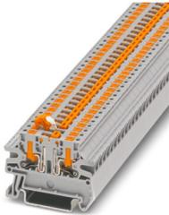
Messertrennklemme, Nennspannung: 400 V, Nennstrom: 20 A, Anschlussart: Push-in-Anschluss, Bemessungsquerschnitt: 2,5 mm<sup>2</sup>, Querschnitt: 0,14 mm<sup>2</sup> - 4 mm<sup>2</sup>, Montage: NS 35/7,5, NS 35/15, Farbe: grau
