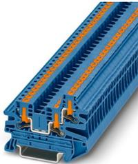
Durchgangsklemme, Nennspannung: 800 V, Nennstrom: 24 A, Anzahl der Anschlüsse: 3, Anschlussart: Push-in-Anschluss, Bemessungsquerschnitt: 2,5 mm<sup>2</sup>, Querschnitt: 0,14 mm<sup>2</sup> - 4 mm<sup>2</sup>, Montageart: NS 35/7,5, NS 35/15, Farbe: blau
