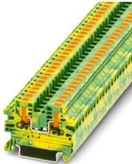
Schutzleiter-Reihenklemme, Anzahl der Anschlüsse: 2, Anschlussart: Push-in-Anschluss, Bemessungsquerschnitt: 2,5 mm<sup>2</sup>, Querschnitt: 0,14 mm<sup>2</sup> - 4 mm<sup>2</sup>, Montageart: NS 35/7,5, NS 35/15, Farbe: grün-gelb
