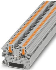
Durchgangsklemme, Nennspannung: 800 V, Nennstrom: 24 A, Anzahl der Anschlüsse: 2, Polzahl: 1, Anschlussart: Push-in-Anschluss, Bemessungsquerschnitt: 2,5 mm<sup>2</sup>, Querschnitt: 0,14 mm<sup>2</sup> - 4 mm<sup>2</sup>, Montageart: NS 35/7,5, NS 35/15, Farbe: grau
