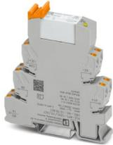
PLC-INTERFACE für hohe Einschaltströme, bestehend aus Grundklemme PLC-BPT.../1 IC/ACT mit Push-in-Anschluss und steckbarem Miniaturrelais, zur Montage auf Tragschiene NS 35/7,5, max. Einschaltstrom bis 130 A, 1 Schließer , Eingangsspannung 12 V DC
