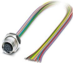
Gerätesteckverbinder Hinterwand, 12-polig, Buchse, gerade, M12-SPEEDCON, A-Kodierung, auf freies Leitungsende, Einzellitzen, Kabellänge: 1,2 m, 0,14 mm<sup>2</sup>, TPE-Litze, vergossen, dieser Artikel ist voraussichtlich ab 2026-Q3 nach RoHS II ohne Ausnahme 6c (Pb < 0,1 %) bleifrei, auf Anfrage ist eine bleifreie Alternative vorab möglich
