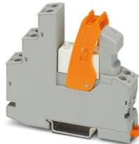
Vormontiertes Relaismodul mit Schraubanschluss, bestehend aus: Relaissockel, Leistungskontaktrelais, steckbarem Anzeige-/ Entstörm modul, Haltebügel. Kontaktausführung: 1 Schließer, max. Einschaltstrom bis 800 A, Eingangsspannung 24 V DC
