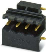
Leiterplatten-Grundleiste, Farbe: schwarz, Kontaktoberfläche: Au, Kontaktart: Stift, Anzahl der Reihen: 1, Polzahl: 4, Artikelfamilie: MSTBO 2,5/..-G1R THR Au, Rastermaß: 5 mm, Montage: THR-Löten, Pin-Layout: Lineares Pinning, Pinlänge [P]: 2,5 mm, Anzahl der Lötpins pro Potenzial: 1, Stecksystem: COMBICON MSTB 2,5, Ausrichtung Steckgesicht: Orthogonal, Verriegelung: ohne, Verpackungsart: Gurt in 44 mm Breite, Artikel mit seitlichem Pinabgang rechts
