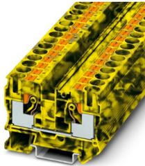
Durchgangsklemme, Nennspannung: 1000 V, Nennstrom: 57 A, Anzahl der Anschlüsse: 2, Anschlussart: Push-in-Anschluss, Bemessungsquerschnitt: 10 mm<sup>2</sup>, Querschnitt: 0,5 mm<sup>2</sup> - 16 mm<sup>2</sup>, Montageart: NS 35/7,5, NS 35/15, Farbe: schwarz/gelb
