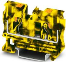
Durchgangsklemme, Nennspannung: 1000 V, Nennstrom: 41 A, Anzahl der Anschlüsse: 2, Anschlussart: Push-in-Anschluss, Bemessungsquerschnitt: 6 mm<sup>2</sup>, Querschnitt: 0,5 mm<sup>2</sup> - 10 mm<sup>2</sup>, Montageart: NS 35/7,5, NS 35/15, Farbe: schwarz/gelb
