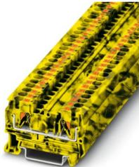
Durchgangsklemme, Nennspannung: 800 V, Nennstrom: 32 A, Anzahl der Anschlüsse: 2, Anschlussart: Push-in-Anschluss, Bemessungsquerschnitt: 4 mm<sup>2</sup>, Querschnitt: 0,2 mm<sup>2</sup> - 6 mm<sup>2</sup>, Montageart: NS 35/7,5, NS 35/15, Farbe: schwarz/gelb
