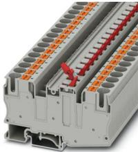
Messertrennklemme, Nennspannung: 500 V, Nennstrom: 20 A, Anschlussart: Push-in-Anschluss, Bemessungsquerschnitt: 10 mm<sup>2</sup>, Querschnitt: 0,5 mm<sup>2</sup> - 16 mm<sup>2</sup>, Montage: NS 35/7,5, NS 35/15, NS 32, Farbe: grau
