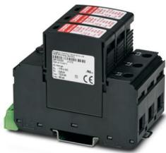
Überspannungsschutzgerät, UL-gelistet Typ 1 und IEC Typ 2, dreikanalig mit Fernmeldekontakt, für 277/480 V AC, 4 Adern.
