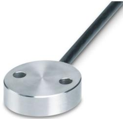
PV-Modultemperatursensor der Lambrecht Meteo GmbH besteht aus Pt 100 Modbus-Umsetzer und Pt 100-Temperatursensor. Der Messwert steht per Modbus/RTU (RS-485) zur Verfügung.
