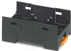
Tragschienegehäuse, Gehäuseunterteil mit Fußriegel, flache Bauform, ohne Lüftungsschlitze, Breite: 45,1 mm, Höhe: 75 mm, Tiefe: 30,3 mm, Farbe: schwarz (ähnlich RAL 9005), Querverbindung: ohne Busverbinder, Polzahl Querverbinder: nicht relevant
