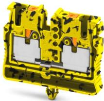
Minidurchgangsklemme, Nennspannung: 800 V, Nennstrom: 24 A, Anzahl der Anschlüsse: 2, Polzahl: 1, Anschlussart: Push-in-Anschluss, Bemessungsquerschnitt: 2,5 mm<sup>2</sup>, Querschnitt: 0,14 mm<sup>2</sup> - 4 mm<sup>2</sup>, Montageart: Rastzapfenmontage, Farbe: schwarz/gelb
