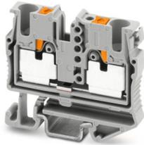
Minidurchgangsklemme, Nennspannung: 800 V, Nennstrom: 24 A, Anzahl der Anschlüsse: 2, Polzahl: 1, Anschlussart: Push-in-Anschluss, Bemessungsquerschnitt: 2,5 mm<sup>2</sup>, Querschnitt: 0,14 mm<sup>2</sup> - 4 mm<sup>2</sup>, Montageart: NS 15, Farbe: grau
