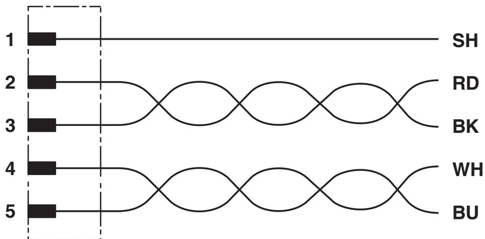
Kontaktbelegung des M12-Steckers
