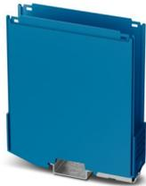
Tragschienengehäuse, Gehäuseunterteil mit Metallfußriegel, Etage 1: mit Lüftungsschlitzen, Breite: 25 mm, Höhe: 100 mm, Tiefe: 108,35 mm, Farbe: blau (ähnlich RAL 5015), Querverbindung: Tragschienen-Busverbinder (optional), Polzahl Querverbinder: 8
