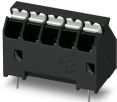
Leiterplattenklemme, Nennstrom: 17,5 A, Bemessungsspannung (III/2): 160 V, Nennquerschnitt: 1,5 mm<sup>2</sup>, Anzahl der Reihen: 1, Polzahl pro Reihe: 5, Artikelfamilie: SPTA 1,5/...-THR, Rastermaß: 3,81 mm, Anschlussart: Push-in-Federanschluss, Montage: THR-Löten / Wellenlöten, Anschlussrichtung Leiter/Platine: 45 °, Farbe: schwarz, Pin-Layout: Lineares Pinning, Pinlänge [P]: 2,6 mm, Anzahl der Lötpins pro Potenzial: 1, Verpackungsart: Gurt in 44 mm Breite
