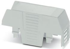
Tragschienegehäuse, Gehäuseoberteil, flache Bauform, einseitige Anschlussöffnung, einseitige Anschlussöffnung, Breite: 22,6 mm, Höhe: 75,26 mm, Tiefe: 36,95 mm, Farbe: lichtgrau (ähnlich RAL 7035)
