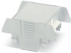
Tragschienegehäuse, Gehäuseoberteil, hohe Bauform, beidseitige Anschlussöffnung, beidseitige Anschlussöffnung, Breite: 52,6 mm, Höhe: 75 mm, Tiefe: 36,95 mm, Farbe: lichtgrau (ähnlich RAL 7035)
