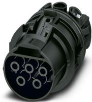
Kontaktträger, Artikelfamilie: PRC 35, Bauform: Entriegelung mit Werkzeug oder von Hand (siehe Zubehör), Farbe: schwarz, Polzahl: 5, Aderquerschnitt min.: 1,5 mm<sup>2</sup>, Aderquerschnitt max.: 6 mm<sup>2</sup>, Bemessungsspannung: 690 V AC, Bemessungsstrom: 35 A, Anschlussart: Schraubanschluss, Kontakteinsatz ohne Steckverbindergehäuse. Passende Steckverbindergehäuse bitte entsprechend der Zubehörliste bestellen.
