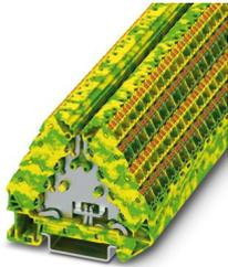
Schutzleiterklemme, Anzahl der Anschlüsse: 16, Polzahl: 2, Anschlussart: Push-in-Anschluss, 1., 2., 3. und 4. Etage, Bemessungsquerschnitt: 1,5 mm<sup>2</sup>, Querschnitt: 0,14 mm<sup>2</sup> - 2,5 mm<sup>2</sup>, Montageart: NS 35/7,5, NS 35/15, Farbe: grün-gelb
