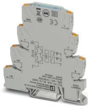
PLC-INTERFACE als elektronisches Wendelastrelais, bestehend aus Grundklemme PLC-BPT.../21 mit Push-in-Anschluss und integrierter Schaltung, zur Ansteuerung von DC-Motoren mit Leuchtanzeige und Schutzbeschaltung, Ausgang: 10 ... 30 V DC/2 A
