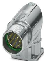
M23, Gerätesteckverbinder Vorderwand, Serie: M23 PRO Signal, gewinkelt drehbar, geschirmt: ja, für Standard- und ONECLICK-Schnellverriegelung, Polzahl: 12, Drehsinn: Gegenlauf, Kontaktart: Stift, Crimpanschluss, Flanschmaß: 26 mm x 26 mm, Kodierung: N, Artikel ist bleifrei nach RoHS II ohne Ausnahme 6c (Pb < 0,1 %)
