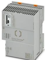
Steuerung (SPS), PLCnext Control; Programmierung: Hochsprache und IEC 61131-3; Betriebssystem: Yocto/Linux® (Echtzeit); Programmierwerkzeug: PLCnext Engineer, Eclipse®, Visual Studio®, MATLAB®/ Simulink®; IoT-Anbindung: PROFICLOUD und jede Cloud über Cloud-Connectoren; Entwicklungsprozess zertifiziert nach IEC 62443-4-1, Produkt zertifiziert nach IEC 62443-4-2 (Zertifizierungsbedingungen siehe Anwenderdokumentation); Prozessor: Intel® Atom® x5-E3930, 2x 1,3 GHz.
