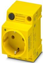
Steckdose, mit Leuchtanzeige, Sicherung 5 x 20 mm, 6,3 A, Steckgesicht Typ CF, Anschlussart: Schraubanschluss, Farbe: gelb, Nennspannung: 250 V AC (50 Hz), Nennstrom: 6 A, zur Montage auf Tragschiene im Service-Interface oder Direktmontage, Normen/Bestimmungen: VDE 0620-1, IEC 60884-1, Länderkennzeichen: Deutschland
