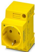
Steckdose, mit Leuchtanzeige, Steckgesicht Typ CF, Anschlussart: Schraubanschluss, Farbe: gelb, Nennspannung: 250 V AC (50 Hz), Nennstrom: 16 A, zur Montage auf Tragschiene im Service-Interface oder Direktmontage, Normen/Bestimmungen: VDE 0620-1, IEC 60884-1, Länderkennzeichen: Deutschland
