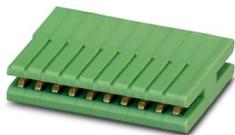
Leiterplattenverbinder, Nennquerschnitt: 1 mm<sup>2</sup>, Farbe: grün, Nennstrom: 8 A, Bemessungsspannung (III/2): 200 V, Kontaktoberfläche: Au, Kontaktart: Buchse, Anzahl der Reihen: 1, Polzahl: 4, Artikelfamilie: ZEC 1,0/..-LPV, Rastermaß: 3,5 mm, Montage: Direktstecktechnik, Anschlussrichtung Leiter/Platine: 0 °, Anzahl der Lötpins pro Potenzial: 2, Stecksystem: ZEC, Verriegelung: ohne, Befestigungsart: ohne, Verpackungsart: verpackt im Karton
