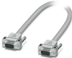
Konfektioniertes, geschirmtes, halogenfreies Rundkabel; Anschluss 1: D-SUB-Buchsenleiste (1x 9-polig); Anschluss 2: D-SUB-Buchsenleiste (1x 9-polig); Kabellänge: 2 m
