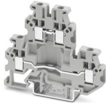
Minidurchgangsklemme, zum Einbau von selbst wählbaren Bauelementen, Nennspannung: 500 V, Nennstrom: 22 A, Anschlussart: Schraubanschluss, Bemessungsquerschnitt: 2,5 mm<sup>2</sup>, Querschnitt: 0,2 mm<sup>2</sup> - 4 mm<sup>2</sup>, Montage: NS 15, NS 35/7,5, NS 35/15, Farbe: grau
