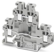
Bauelementreihenklemme, Der max. Strom wird durch die Diode bestimmt. Eingebaut: Diode BY133G, Sperrspannung: 1300 V, Dauergrenzstrom: 0,5 A., mit integrierter Diode, Nennspannung: 500 V, Nennstrom: 0,5 A, Anschlussart: Schraubanschluss, Bemessungsquerschnitt: 2,5 mm<sup>2</sup>, Querschnitt: 0,2 mm<sup>2</sup> - 4 mm<sup>2</sup>, Montage: NS 15, NS 35/7,5, NS 35/15, Farbe: grau
