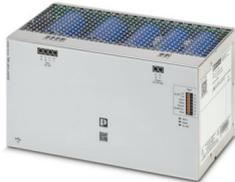
QUINT Kapazitätsmodul, mit wartungsfreiem Energiespeicher auf Doppelschicht-Kondensatorbasis, Tragschienenmontage, Eingang: 24 V DC, Ausgang: 24 V DC / 20 A / 16 kJ inkl. montiertem Universal-Tragschienenadapter UTA 107
