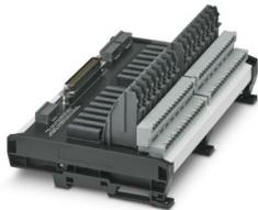
16-kanaliges VIP I/O-Marshalling-Basiselement mit 37-poligem D-SUB-Steckverbinder für den universellen Einsatz. Steckbare Feld- und Versorgungsklemmen als Zubehör erhältlich. Mit Push-in-Anschlussstechnik. Wahlweise für Ex i und Non-Ex.
