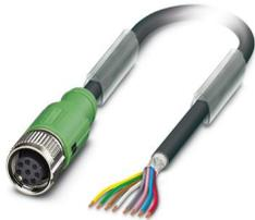
Sensor-/Aktor-Kabel, 8-polig, PUR halogenfrei, schwarzgrau RAL 7021, geschirmt, freies Leitungsende, auf Buchse gerade M12, Kodierung: A, Kabellänge: 20 m
