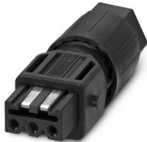
Steckverbinder, Anschlussart: IDC-Anschluss, Polzahl: 3+PE, 0,5 mm<sup>2</sup> ... 1,5 mm<sup>2</sup>, 400 V, 16 A AC/DC, schwarz, mit einer QUICKON-Mutter, Leitungsaußendurchmesser: 7 mm ... 13 mm, Steckverbinder für den Motoranschluss von Raffstoren, Jalousien, Rollläden und Markisen
