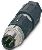
Steckverbinder, Universal, 4-polig, Stecker gerade M12 SPEEDCON, Kodierung: A, Schneidklemmanschluss, Rändelmaterial: Zinkdruckguss, vernickelt, Leitungsaußendurchmesser 3,5 mm ... 6 mm
