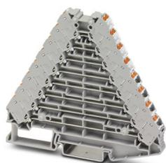
Rangierverteiler, Nennspannung: 250 V, Nennstrom: 8 A, Anschlussart: Push-in-Anschluss, 1., 2., 3., 4., 5., 6., 7. und 8. Etage, Bemessungsquerschnitt: 1,5 mm<sup>2</sup>, Querschnitt: 0,14 mm<sup>2</sup> - 2,5 mm<sup>2</sup>, Montage: NS 35/7,5, NS 35/15, Farbe: grau, Farbe Anschlusselemente: weiß
