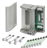
Termination Carrier für 8 1-kanalige MACX Analog (Ex i) Trennverstärker zur Anbindung an das ABB S800 System AO845 (analoge Ausgabe) über die TU812 oder TU854 mit 2-fach redundanter Spannungseinspeisung
