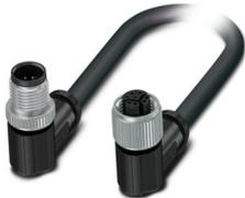
Hybridkabel, Ethernet Hybrid CAT5 (100 MBit/s), 8-polig, PUR halogenfrei, schwarz RAL 9005, geschirmt (Advanced Shielding Technology), Stecker gewinkelt M12, Kodierung: Y / IP65/IP67, auf Buchse gewinkelt M12, Kodierung: Y / IP65/IP67, Kabellänge: 2 m, Power with Ethernet (PWE)
