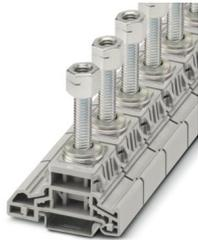
Hochstromverbinder, Nennspannung: 1000 V, Nennstrom: 269 A, Anzahl der Anschlüsse: 1, Anschlussart: Bolzenanschluss, Bemessungsquerschnitt: 120 mm<sup>2</sup>, Montageart: NS 35/7,5, NS 35/15, Farbe: grau
