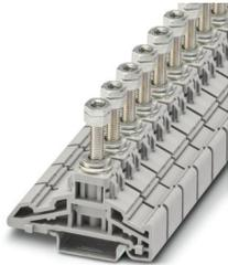
Hochstromverbinder, Nennspannung: 1000 V, Nennstrom: 125 A, Anzahl der Anschlüsse: 1, Anschlussart: Bolzenanschluss, Bemessungsquerschnitt: 35 mm<sup>2</sup>, Montageart: NS 35/7,5, NS 35/15, Farbe: grau
