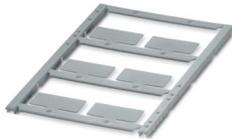
Kunststoffschild, Matte, silber, unbeschriftet, beschriftbar mit: BLUEMARK E.CARD, BLUEMARK ID COLOR, BLUEMARK ID, THERMOMARK PRIME 2.0, THERMOMARK PRIME, THERMOMARK CARD 2.0, THERMOMARK CARD, TOPMARK NEO, TOPMARK LASER, Montageart: kleben, Textfeldhöhe: 12,5 mm, Textfeldbreite: 27 mm
