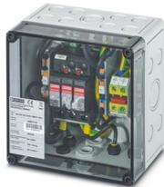
Generatoranschlusskasten für Photovoltaikanlagen bis 1000 V DC zum Anschluss von 1x 2 Strings. Mit Überspannungsschutz (Typ 1/2) und SUNCLIX-DC-Steckverbindern für die Eingangs- und Ausgangsseite (SUNCLIX-Gegenstecker im Lieferumfang).
