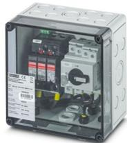
Generatoranschlusskasten für Photovoltaikanlagen bis 1000 V DC zum Anschluss von 1x 1 String. Mit Überspannungsschutz (Typ 1/2), DC-Lasttrennschalter und SUNCLIX-DC-Steckverbindern für die Eingangs- und Ausgangsseite (SUNCLIX-Gegenstecker im Lieferumfang).
