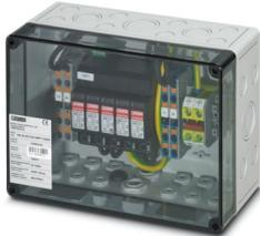
Generatoranschlusskasten für Photovoltaikanlagen bis 1000 V DC zum Anschluss von 2x 2 Strings. Mit Überspannungsschutz (Typ 2) und Kabelverschraubungen für die Eingangs- und Ausgangsseite.
